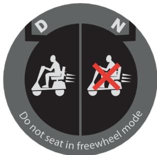
Placez l'unité sur un sol de niveau pour passer du mode conduite « D » au mode roue libre « N » ou inversement.
