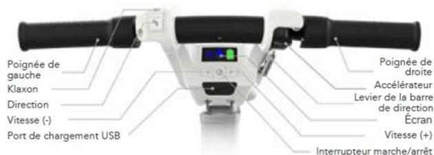
Figure 27 Aperçu de la console de conduite
